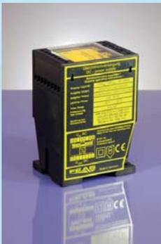
In vielen Fällen ist aus sicherheitstechnischen Gründen eine Überwachung der Pumpen mit 230 V nicht möglich oder empfehlenswert. In diesen Fällen sind Netzgeräte lieferbar, die einen Gleichstrom von 24 V liefern, die Eingangsspannung kann 115/230 V 50/60 Hz betragen. Die Stromstärke beträgt 1,5 A
