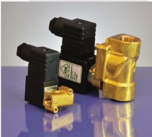
Zum Ein- und Abschalten von Druckluftmembranpumpen werden 2/2-Wege-Magnetventile eingesetzt. Da beim Schließen des Ventils die restliche Luft aus der Leitung zur Pumpe durch die Pumpe entweicht, muss das Ventil nicht entlüften können.
