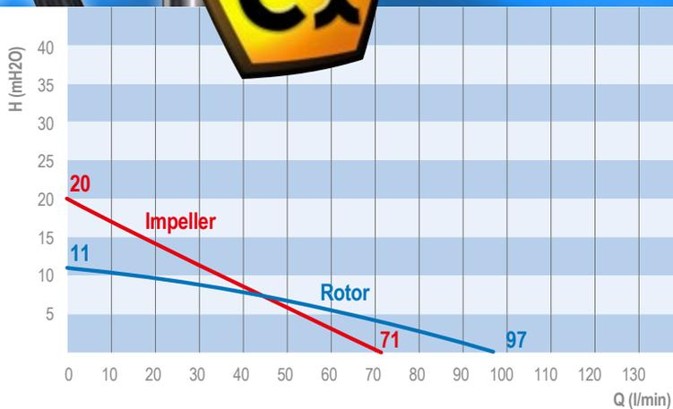
JP-400, 230 VAC, JP-SS 41-1000 Prüfmedium Wasser 20 °C, Druckrohr 1", Ovalradzähler, Messwerte: ± 5%
