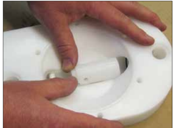
Bild 16. Setzen Sie das Distanzstück (19) umgedreht ein und schieben es nach oben unter den Ventilsitz (20).
