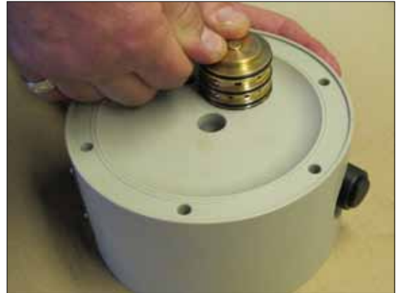
Bild 2. Befeuchten Sie die O-Ringe am Steuerventil mit leicht mit Wasser oder flüssiger Seife. Drücken Sie das Steuerventil (61) vorsichtig in den Mittelblock. Setzen Sie den zweiten Sicherungsring in die Rückseite. (siehe Bild 1).
