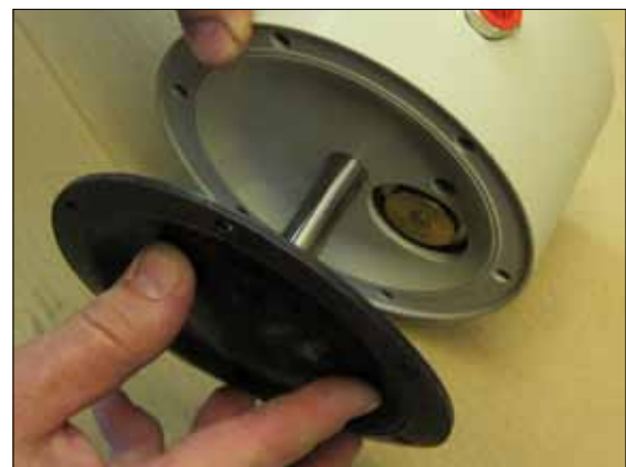
Bild 12. Schrauben Sie die Membrane auf die Kolbenstange (16) und schieben Sie die Einheit durch die Bohrung im Mittelblock. Setzen Sie zweite Membrane so auf, dass die Löcher für die Zuganker fluchten.
