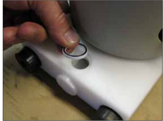
Bild 21. Setzen Sie die kleinen O-Ringe (18) in den Sitz des Gehäuses. Bei Pumpen mit PTFE-Membranen wird der PTFE-U-Ring mit dem kleinen O-Ring nach oben montiert.
