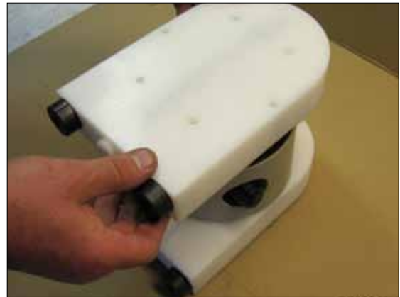
Bild 23. Setzen Sie zuerst das verbliebene Gehäuse vorsichtig auf und legen Sie dann die Verstärkungsplatte auf.
