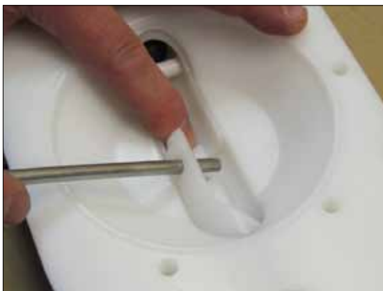
Bild 17. Stecken Sie einen der Zuganker in das Loch des Distanzstückes (19) und drehen es vorsichtig. Mit leichten Schlägen eines Kunststoffhammers wird es in Position gebracht.
