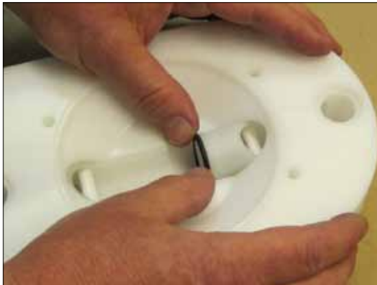
Bild 15. Montieren Sie die obere Ventilsitzeinheit: Ventilsitz (20), Ventilkugel (23), Kugelfangstift (22) und O-Ring (43).
