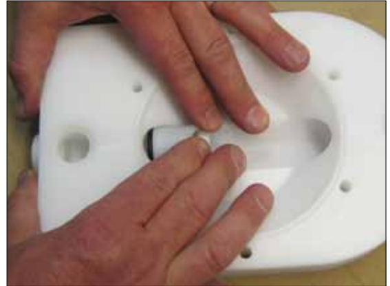
Bild 14. Schieben Sie die Ventilsitzeinheit unten in das Gehäuse (11).
