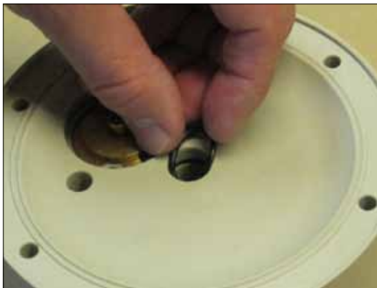
Bild 9. Setzen Sie O-Ring Mittelblockdichtung (47) in die Nut.
