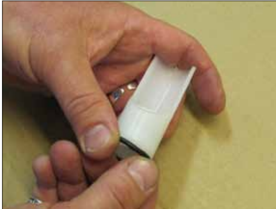
Bild 13. Legen Sie die Ventilkugel (23) in den unteren Ventilsitz (21) und stecken den Kugelfangstift (22) ein. Setzen Sie den Dichtring (43) unten auf den Ventilsitz.
