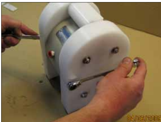
Bild 22. Stecken Sie die Anschlussstücke (13) in das Gehäuse und stellen Sie sicher, dass alle O-Ringe (18) richtig platziert sind.
