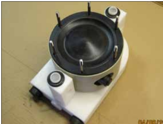
Bild 22. Stecken Sie die Anschlussstücke (13) in das Gehäuse und stellen Sie sicher, dass alle O-Ringe (18) richtig platziert sind.
