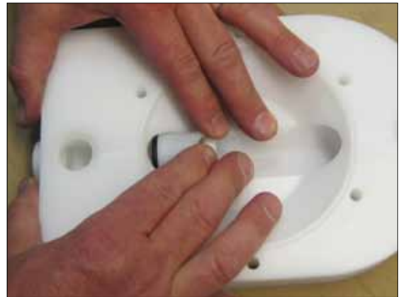
Bild 14. Schieben Sie die Ventilsitzereinheit unten in das Gehäuse (11).
