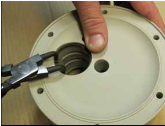
Bild 1. Setzen Sie den Sicherungsring (27) auf einer Seite ein.
