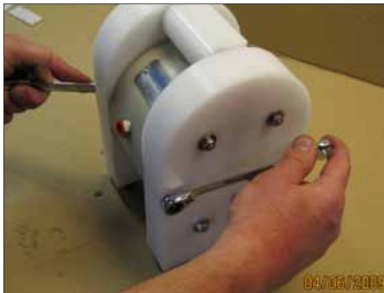
Bild 24. Ziehen Sie die Muttern (37) mit Unterlegscheiben über Kreuz an. Beachten Sie hierzu die empfohlenen Drehmomente in Kapitel 5.
