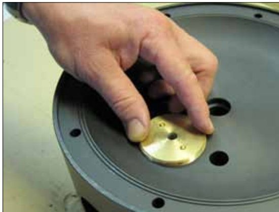
Bild 3. Schrauben Sie vorsichtig eine Endkappe mit Hand in den Mittelblock. Eventuell müssen Sie erst gegen den Uhrzeigersinn drehen, bis das Gewinde sitzt.
