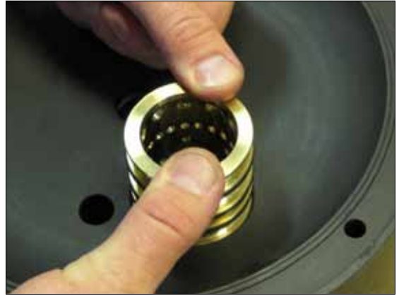
Bild 6. Stellen Sie sicher, dass alle 4 O-Ringe (30) auf der Hülse sitzen. Befeuchten Sie die O-Ringe mit Wasser oder Flüssigseife zum leichteren einsetzen. Kein Fett oder Öl nehmen.
