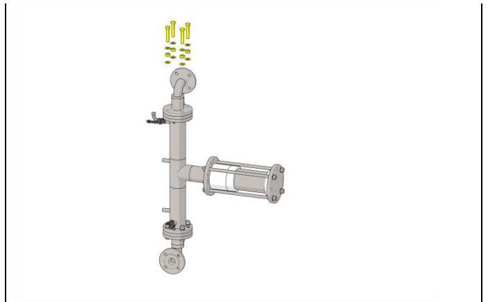
Fig. 3.6.5a Lösen und entfernen Sie acht Sechskantschrauben [38], die den Druckstutzen [3] mit den Gehäusen [1] verbinden.
