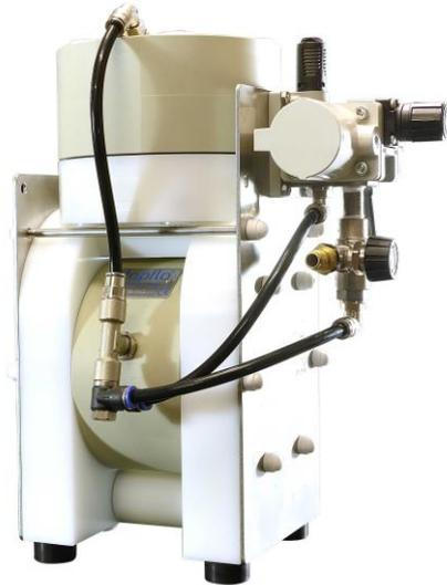
Bei der Pumpenreihe TFK ist unbedingt darauf zu achten, dass die Druckluftversorgung für den integrierten Pulsationsdämpfer am Ausgang des Druckübersetzers, also am Drucklufteinlass der Pumpe abgenommen wird. Wenn die Pumpen von uns geliefert werden, ist dies bereits erfolgt. Dies gilt generell für alle TF-Pumpen, die auf der Druckseite einen aktiven Pulsationsdämpfer installiert haben.
