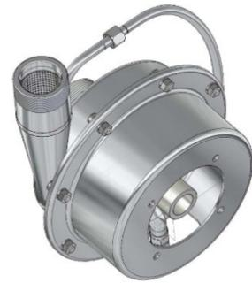
Die gespülten Dichtungsrohre sind vollständig demontierbar. Entfernen Sie den oberen Flansch und bauen Sie den Filter aus, um den selbstreinigenden Filter zum Entfernen von angesammelten „großen“ Partikeln oder für Routineinspektionen zu zerlegen. Zur einfachen Demontage ist die Spülstahlrohrleitung mit Gasarmaturen befestigt.
