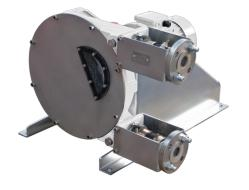
topflo® Schlauchpumpen Schlauchpumpen für industrielle Anwendungen in Hochdruckausführung bis 15 bar als Nassläufer oder für niedrige Drücke als Trockenläufer. Viele Werkstoffe und Ausführungen, bis DN 125.
